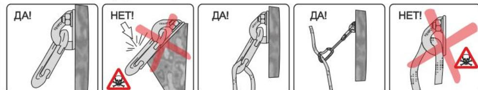
**Рис. 7. Установка и использование анкерного устройства с кольцом**
